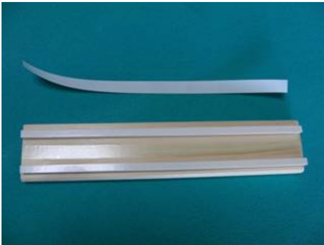
床台のシールをはがし、磁石のN極を上にし、スペーサーを使いながら磁石をはる
