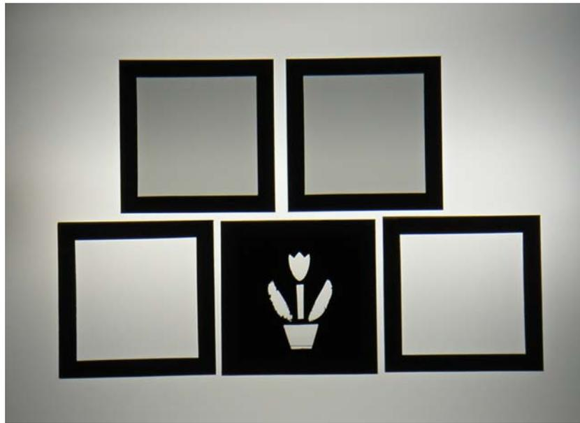
偏光フィルムカード 2枚 (A、B)、クリアーカード2枚 チューリップの絵を用意。
