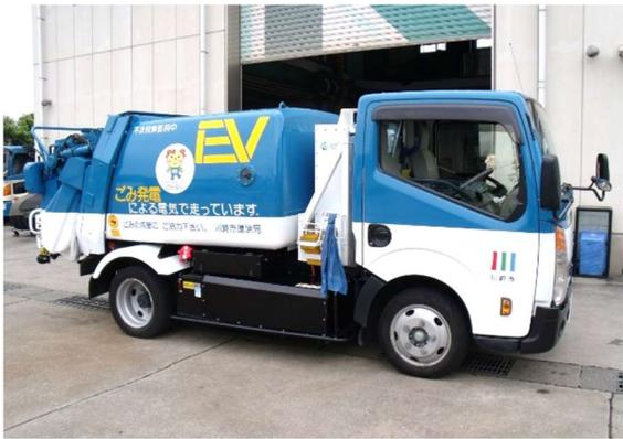
川崎分会です。今回は川崎市で1台しかないEV車の紹介をしたいと思えます。浮島処理センターでゴミを燃やして発電した電気を、処理センター内に設置した電池ステーションで充電し(世界で唯一)その充電池を使って100%電気です。地球環境にやさしい収集車です。ただし、充電池の重量の関係で最大積載量が1350kgになっていきます。川崎市の重要政策としてEV車の広報も兼ねて川崎区内の重要拠点を中心に再任用
