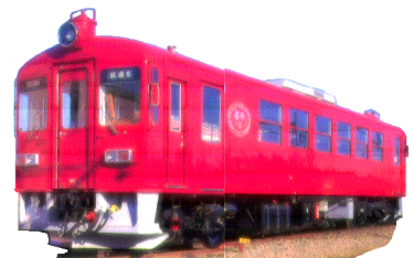
図-1 富士重工業製軽快気動車 くりはら田園鉄道 KD95型 全国唯一の民鉄からの三セク化例 電車を気動車に替えた
