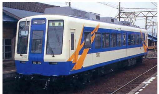
図-4 京福 5001型 車体は武庫川車両で新製 電気品・台車は中古品
