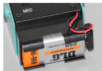
写真-4 外付けした電池ケース
